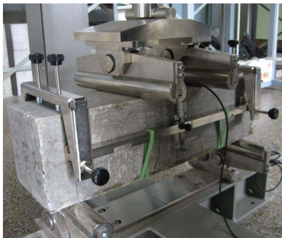
Figura 1: Izq. Vista de los dispositivos de ensayo. Der: configuración de carga y curva del HRF.
