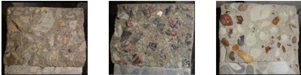
Figura 1. Aspecto típico de las superficies de fractura en tracción de los hormigones elaborados con los tres tipos de agregados. Izq.: Dolomita; Centro: Granito; Der.: Canto Rodado.
