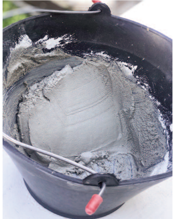
Aspecto de una mezcla "gorda" (nótese la textura cerrada del mortero y la suavidad de su superficie)
